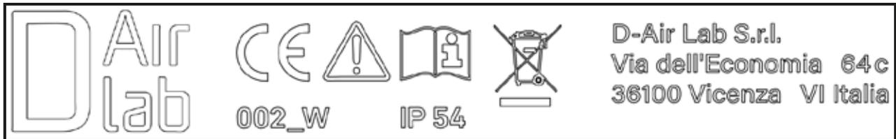
Die Kennzeichnung wird direkt auf das Plastikgehäuse gedruckt und enthält folgende Angaben:
