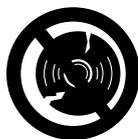
Trennschleifscheibe öfter prüfen – sofort ersetzen, wenn sich Risse, Wölbungen oder andere Schäden (z. B. Überhitzung) zeigen – durch Bruch **Unfallgefahr!**
