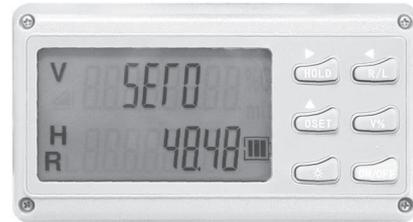
Nach dem Einschalten und Initialisieren des Vertikalkreises erscheint eine der nebenstehenden Abbildung ähnliche Anzeige.
