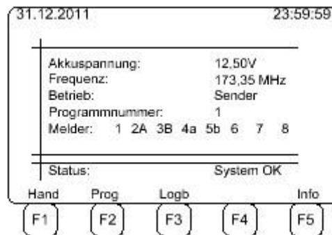
Im Betrieb wird standardmäßig die größere der beiden Akkuspannungen, die Kommunikationsfrequenz, die Betriebsart, die Programmnummer und die aktiven Melder angezeigt. Die Zahlen geben die Signalgruppe wieder und die Buchstaben sind wie folgt definiert:
