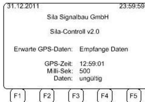
Dieser Bildschirm zeigt die Softwareversion von Sila-Controll-Brain und die Empfangsdaten von der GPS-Antenne.
