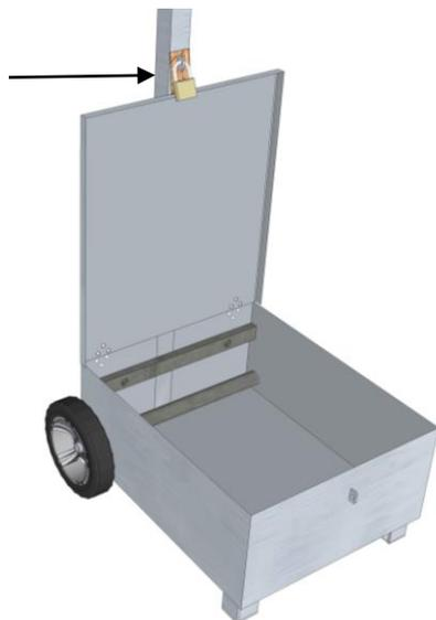
(Bild Sichern des Metalldeckels mit einem Schloss)
