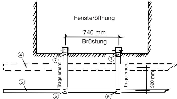
Das Trägergestell wird in die Tragelemente gestellt (6) und mit den Kupplungen (7) befestigt.
