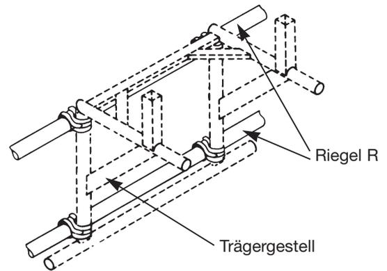
Bei einseitiger Anordnung gemäß  $\boxtimes$  sind Riegel aus Rohr 60,3 - 5,0 - ST 37 erforderlich, welche mit Reduzierkupplungen anzuschließen sind. Für andere Arten von Riegeln ist ein statischer Nachweis im Einzelfall erforderlich.
