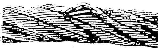
Verschleiß = Materialverlust unregelmässige Oberfläche
