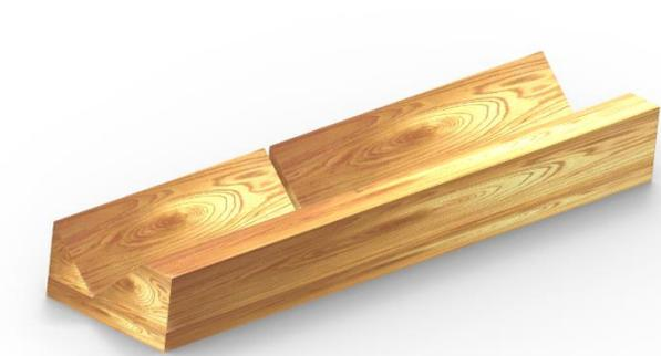
Mit Hilfe der Schmiegenlehre (im Zubehör erhältlich) werden zwei Dreikantleisten hergestellt. Mit einem Brett werden die beiden Dreikantleisten zusammengenagelt. Nun hat man ein Prisma. An der Schnittstelle wird das Prisma eingesägt. (siehe Maßzeichnung).
