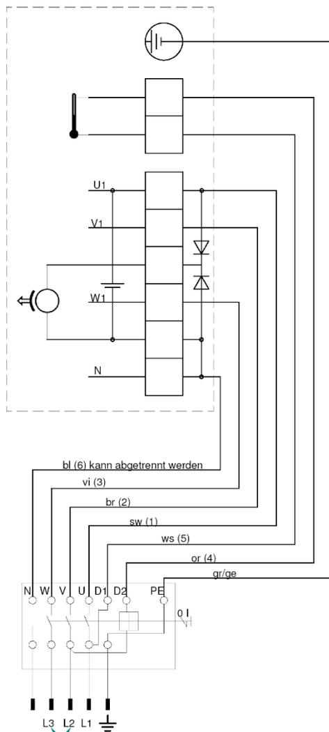
Die Drehrichtung des Motors ist mit Hilfe des Phasenwenders am Gerätestecker umkehrbar.
