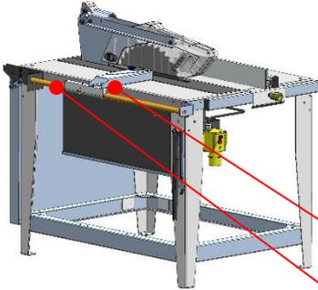
1. die beiden Sechskantschrauben lösen
