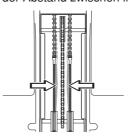
3 Bei Bedarf können die Seilzüge durch Anziehen der Stellmuttern an jeder Seite des Lenkkranzes gespannt werden. Die Seilzüge nicht zu fest spannen, sie sollen nur straff am Lenkkranz anliegen.
