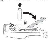
Der Hebel kann auch zur vorübergehenden Regelung der Mähhöhe, z. B. bei einer kleineren Erhöhung im Rasen, benutzt werden.
