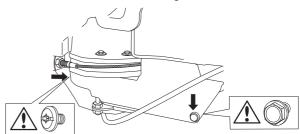
Mit Fettspritze schmieren; einen Nippel von der rechten Seite unter der unteren Riemenscheibe des Motors, bis das Fett vordringt. Bei täglichem Gebrauch zweimal wöchentlich schmieren.
