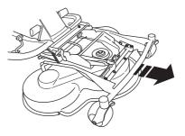
Das Schneidwerk bis zum Anschlag herausheben. Ein Klicken ertönt. Das Schneidwerk wird automatisch in der senkrechten Stellung gesichert.
