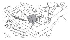
Die Gummidichtung des neuen Ölfilters leicht mit neuem Öl schmieren. Ölfilter im Uhrzeigersinn drehend montieren. Manuell drehen, bis die Gummidichtung anliegt. Dann noch eine halbe Umdrehung anziehen.
