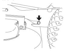
Antriebsriemen um das Antriebsrad des Aggregates legen. Sicherstellen, dass der Riemen auf der richtigen Seite der Riemenspannrolle platziert ist.
