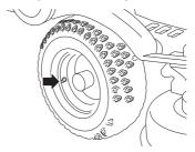
ACHTUNG! Unterschiedlicher Luftdruck in den Vorderreifen führt dazu, dass die Messer das Gras nicht gleichmäßig schneiden. Um optimale Leistung zu erzielen und Schäden am Gerät zu vermeiden, ist es wichtig, dass alle Reifen denselben Luftdruck aufweisen
