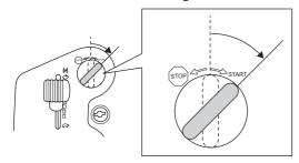
6 Nach Anspringen des Motors den Zündschlüssel sofort in die Ausgangslage zurückfedern lassen.
