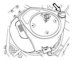
Messstab wieder einführen. Der Messstab muss ganz eingeschraubt sein
