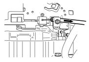
3 Gashebel auf Vollgas zurückziehen und sicherstellen, dass der Choke nicht mehr betätigt ist.
