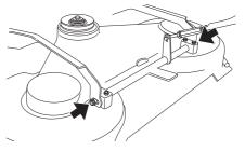
7 Die Schrauben an der Schneidabdeckung entfernen. Geräterahmen anheben und Abdeckung des Schneidwerks entfernen.
