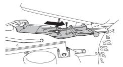
8 Frontabdeckung sowie rechten Kotflügel montieren.
