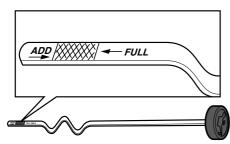
Das Öl wird durch die Öffnung nachgefüllt, in der der Messstab sitzt. Öltank langsam mit Öl füllen.
