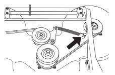
9 Die Montage des neuen Riemens erfolgt in umgekehrter Reihenfolge.
