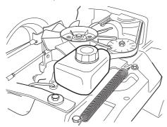
**Rider 318** Bei Bedarf mit Motoröl SAE 10W/40 (Klasse SF-CC) auffüllen.
