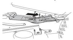
3 Muttern der Parallelstrebe lösen.
