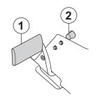
3 Der Motor kann nur gestartet werden, wenn die Feststellbremse gedrückt wird.
