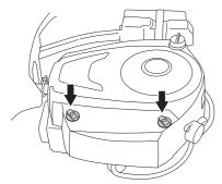
3 Den Filtereinsatz aus dem Filtergehäuse nehmen.
