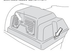
2 Sicherstellen, dass der Getriebeöltank Öl enthält.
