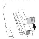
3 Sperre des Schneidwerks öffnen.
