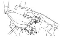
8 Die Feder lösen, mit der der Keilriemen gespannt wird, und den Riemen abziehen.
