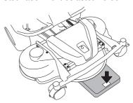
5 Den Bodendruck des Schneidwerks durch Ein- oder Herausdrehen der Stellschrauben an beiden Seiten hinter den Vorderrädern einstellen. Der Bodendruck soll 12 bis 15 kg (26,5-33 lb) betragen.
