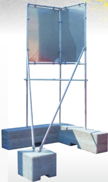
Mit Pipeclamps Rohrverbindern ist es möglich, nur unter Verwendung eines Inbusschlüssels, kostengünstige und komplexe Konstruktionen zu erstellen. Die feuerverzinkten Temperegussfittings sind für  $\frac{6}{4}$ " (48,3 mm)  $\varnothing$  Standardstahlrohre geeignet.
