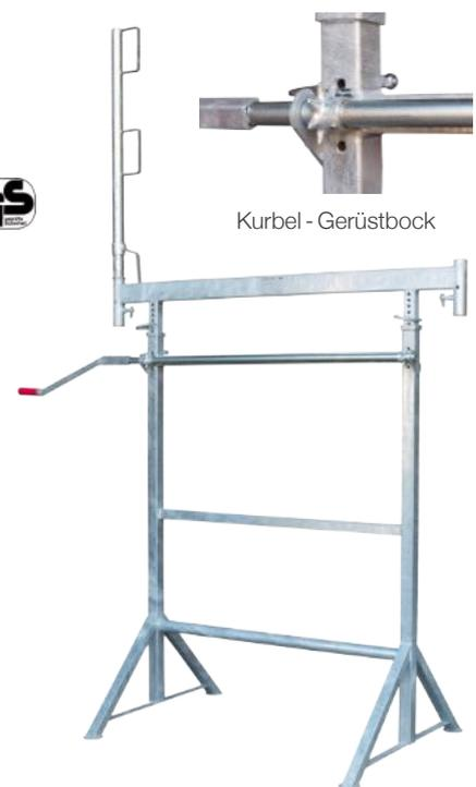
**Bitte beachten Sie, dass die Gerüstböcke ab einer Aufbauhöhe von 2,0 m mit Gerüstrohren und -Kupplungen diagonal ausgesteift werden müssen.**
