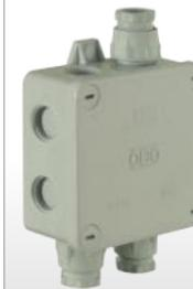
**Abzweigdose B9 / KM**Feuchtraum - Oberputz Abzweigdose mit 7 Kabelein- bzw. -ausgängen und 3 schraubbaren Zugentlastungen, Schutzart IP 67
