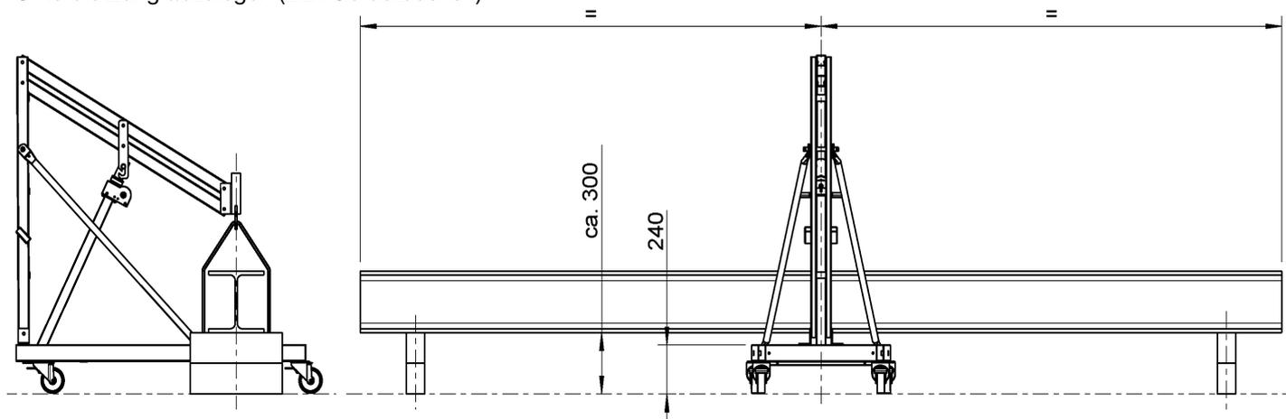
Nach Montage der Kopfgabel und gegebenenfalls des Adapters, ist der Träger (die Last) wiederum **MITTIG** im Schwerpunkt aufzunehmen. Bohrungen in der Platte der Kopfgabel ermöglichen eine zusätzliche Befestigung des Trägers. Während des Hubs empfiehlt es sich, die Unterstüzung stets nachzuführen und so für eine zusätzliche Kipp- und Fallsicherung zu sorgen. Der Kragarmlift darf mit aufgenommener Last ausschließlich in seiner Längsrichtung verfahren werden!
