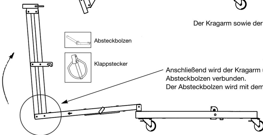
Nun erfolgt das Aufrichten und Fixieren des Ständers durch Aufstecken der Streben auf die Gabelbolzen an Ständer und Fahrgestell.
