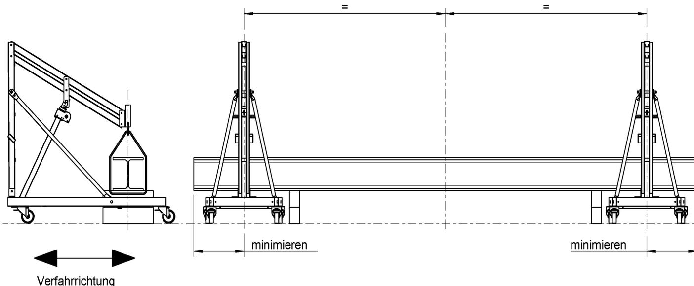
Nach Montage der Kopfgabeln und gegebenenfalls der Adapter, ist der Träger (die Last) wiederum **SYMMETRISCH** zum Schwerpunkt aufzunehmen. Bohrungen in den Platten der Kopfgabeln ermöglichen eine zusätzliche Befestigung des Trägers. Während des Hubs empfiehlt es sich, die Unterstüztung stets nachzuführen und so für eine zusätzliche Kipp- und Fallsicherung zu sorgen. Die Kragarmlifte dürfen mit aufgenommener Last ausschließlich in deren Längsrichtung verfahren werden!
