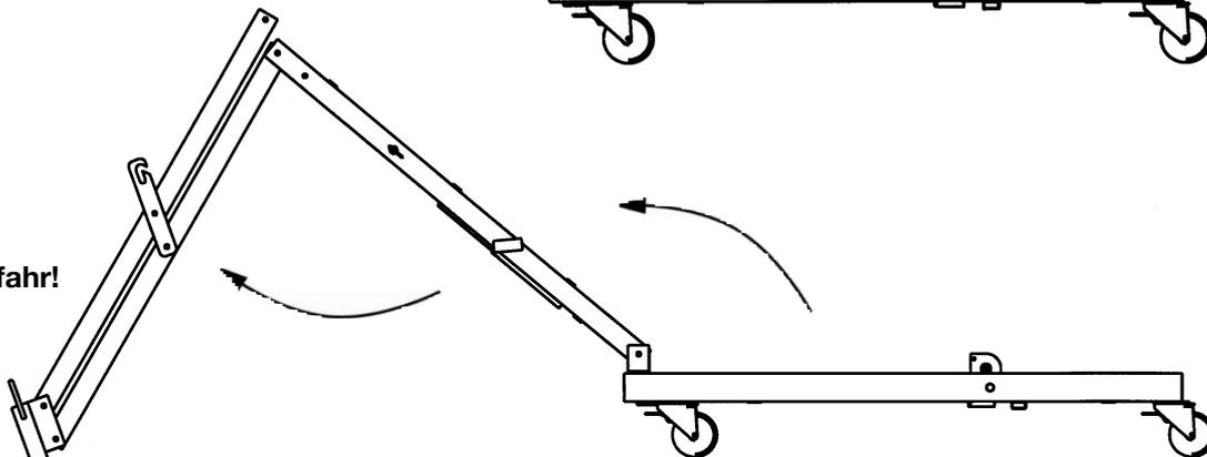
Der Kragarm sowie der Ständer werden ausgeklappt.
