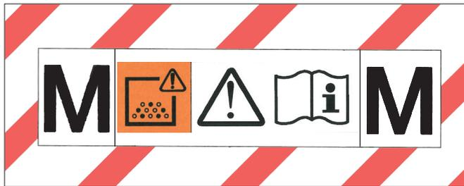
**SRB** **UPOZORENJE:** Ovaj uređaj sadrži prašinu koja je štetna po zdravlje. Pražnjenje i održavanje uređaja, uključujući i uklanjanje vrećice s prašinom, smeju izvoditi samo stručnjaci koji nose odgovarajuću zaštitnu opremu. Ne uključujte pre nego što se ugradi kompletan filtracioni sistem i provjeri funkcionalnost kontrole protoka.
