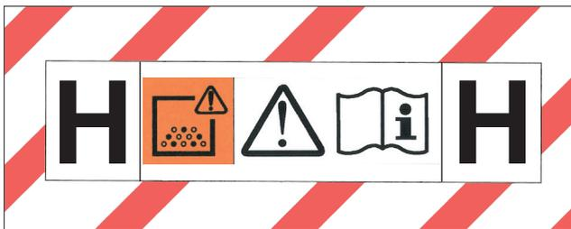
**D** **WARNUNG:** Dieses Gerät enthält gesundheitsgefährliche Stäube. Entleerung und Wartung, einschließlich der Entfernung des Staubbeutels, dürfen nur von sachkundigen Personen vorgenommen werden, die geeignete persönliche Schutzausrüstung tragen. Nicht einschalten, bevor das komplette Filtersystem installiert ist und die Funktion der Volumenstromkontrolle überprüft wurde.
