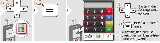
Das Messergebnis aus der Hauptzeile wird in den Rechner übernommen und kann für weitere Berechnungen herangezogen werden.
