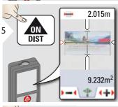
Pfeile mit den Cursortasten oder durch Antippen des Displays auswählen und mit den Softkeys verschieben. Die entsprechende Fläche wird berechnet.
