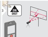
Lotrecht auf die horizontale Mittellinie der Fläche zielen. Diese Fläche muss absolut eben auf der vertikalen Ebene liegen.
