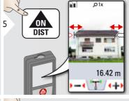
Pfeile mit den Cursortasten oder durch Antippen des Displays auswählen und mit den Softkeys verschieben. Die entsprechende Breite wird berechnet.
