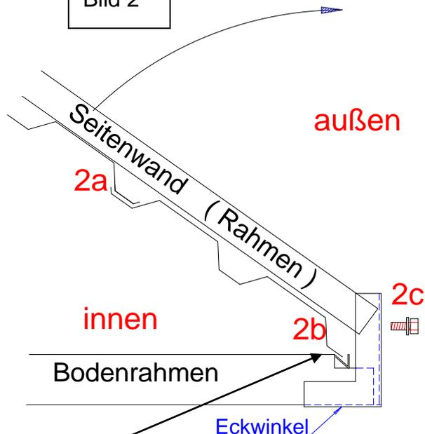
Unteres Seitenwandblech in das Bodenprofil einführen
