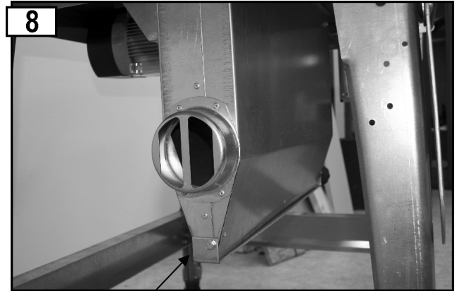
Spanauswurfschlitz geschlossen (Betrieb mit Späneabsaugvorrichtung)
