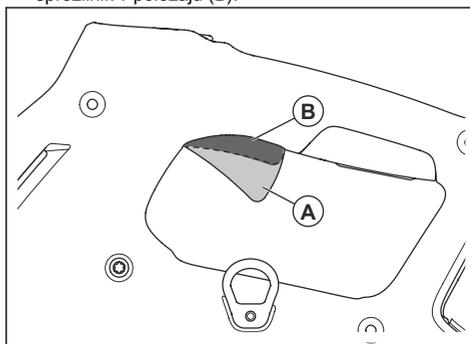
**Opomba:** V sprožilniku je upor, ki ločuje standardni način (A) od načina povečane moči (B).
