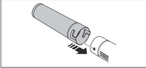
2. Drücken Sie die Ausblasöffnung vollständig an und drehen Sie sie, bis sie in das Gerät einrastet.
