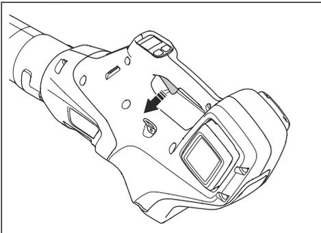
4. Drücken Sie erneut auf die Taste zur Geschwindigkeitsregelung, um die Geschwindigkeitsregelung zu deaktivieren.
