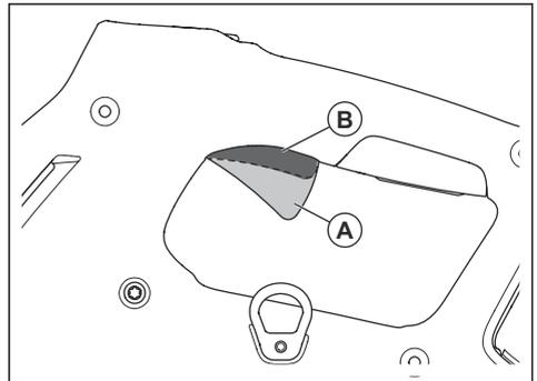
**Hinweis:** Es gibt einen Widerstand im Gashebel, durch den der Standard-Modus (A) vom Boost-Modus (B) getrennt wird.
