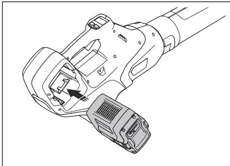
3. Pritisnite spodnji del akumulatorja in ga tako potisnite do konca v izdelek. Akumulator se pravilno zaskoči, ko slišite klik.
