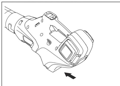
2. Sprostite sprožilnik plina in po potrebi odstranite listje ali neželeni material.
